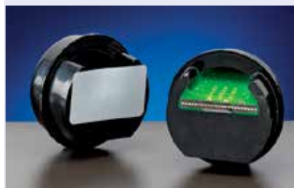
Полимерный барьер (05756907) для использования с фиксатором образцов
