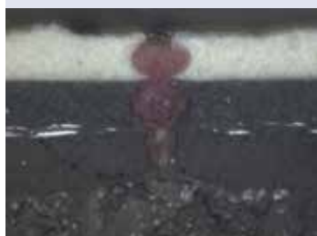
Газовые пузырьки оцинкованного листового металла Диаметр около 20 мкм
