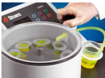
Быстрая и легкая заливка с держателем заливочных формочек Struers
