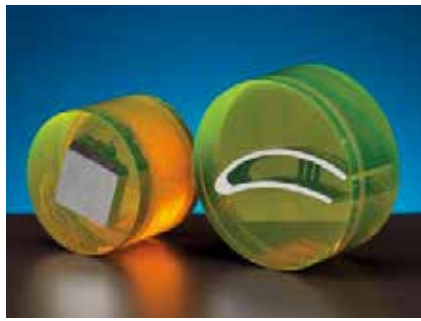
Стальные детали, запрессованные в EpoFix и EpoDye
