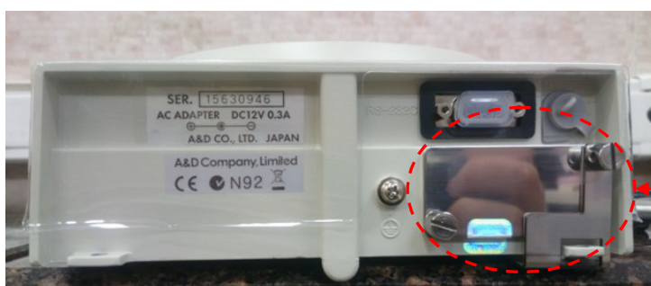
Рисунок 2 - Схема пломбировки весов от несанкционированного доступа
